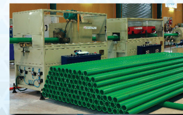
Máy đùn ống PPR PPR extrusion lines
