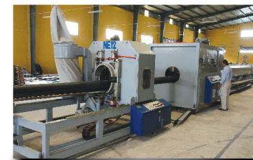
Máy đùn ống HDPE đường kính nhỏ HDPE extrusion lines for small diameter
