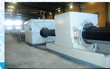
Máy đùn ống HDPE đường kính lớn HDPE large diameter pipe extrusion lines
